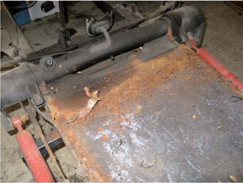
Un aperçu de l'état du châssis
